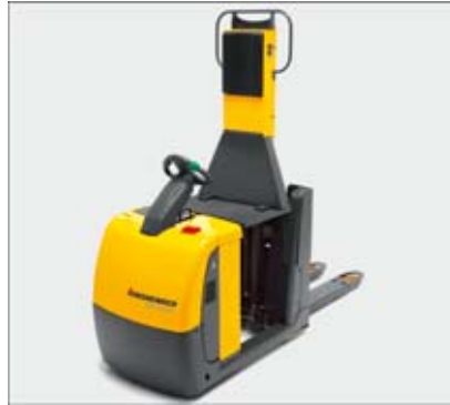
Seleção de pedidos no 2. andar das prateleiras através da elevação da plataforma do motorista
